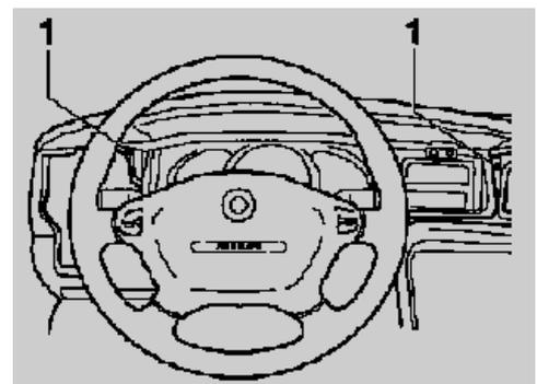
Stecker vom MID/TID mit Schraubendreher entriegeln und abziehen. Instrumentenzusammenbau zur Fahrzeugmitte herausnehmen.
